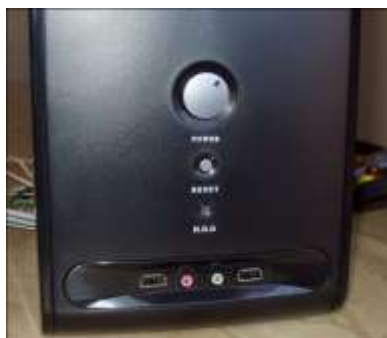
ภาพที่ 7.8 ภาพสวิตช์เปิดปิดและสวิตช์รีเซ็ตด้านหน้าเครื่องคอมพิวเตอร์
