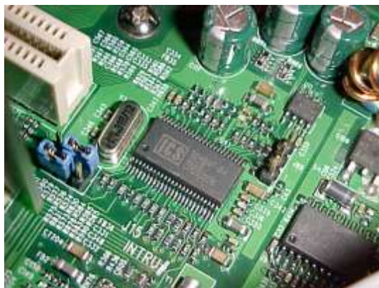
ภาพที่ 4.6 วงจรกำเนิดสัญญาณนาฬิกา (Clock Generator)
