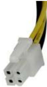
ภาพที่ 4.26 หัวต่อแหล่งจ่ายไฟแบบเอทีเอ็กซ์ 12 โวลต์ (ATX 12 V) และจุดต่อบนเมนบอร์ด ที่มา : http://www.smpsowersupply.com/connectors-pinouts.html , 2559 ที่มา : https://www.overclockzone.com/Adel/11-05/gigabyte_gak8n_pro_sli/ , 2559
