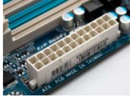
ภาพที่ 4.25 หัวต่อแหล่งจ่ายไฟแบบเอทีเอ็กซ์ (ATX) และจุดต่อบนเมนบอร์ด ที่มา : https://www.techchore.com/parts-motherboard-functions/ , 2559
