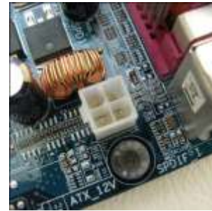
ภาพที่ 4.26 หัวต่อแหล่งจ่ายไฟแบบเอทีเอ็กซ์ 12 โวลต์ (ATX 12 V) และจุดต่อบนเมนบอร์ด ที่มา : http://www.smpsowersupply.com/connectors-pinouts.html , 2559 ที่มา : https://www.overclockzone.com/Adel/11-05/gigabyte_gak8n_pro_sli/ , 2559
