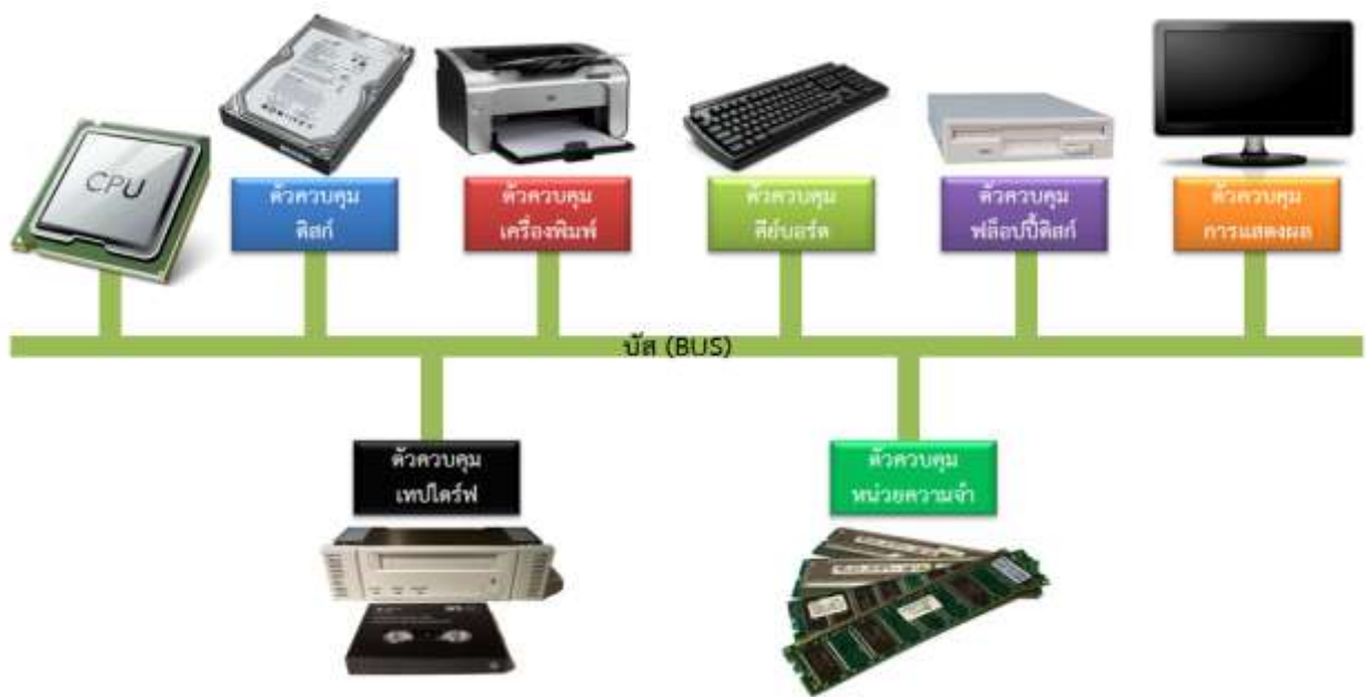
ภาพที่ 2.7 การเชื่อมต่อของอุปกรณ์คอมพิวเตอร์ผ่านบัส (BUS)
