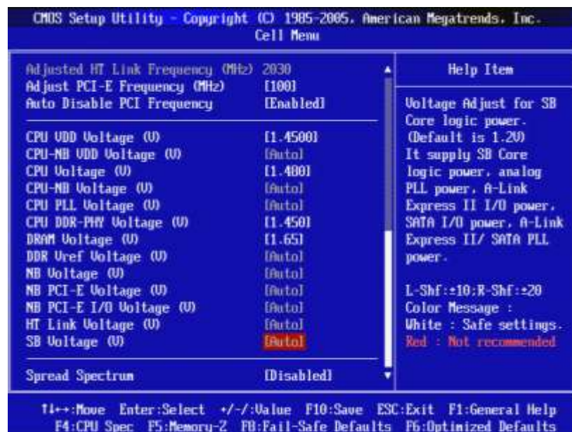
ภาพที่ 13.9 ตัวอย่างตำแหน่งการกำหนดแรงดันให้กับซีพียูยี่ห้อ AMD
