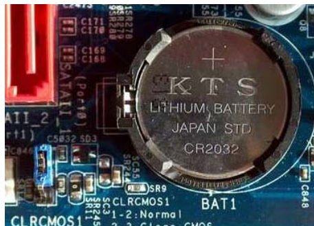
ภาพที่ 7.15 แบตเตอรี่เลี้ยงซีมอส
