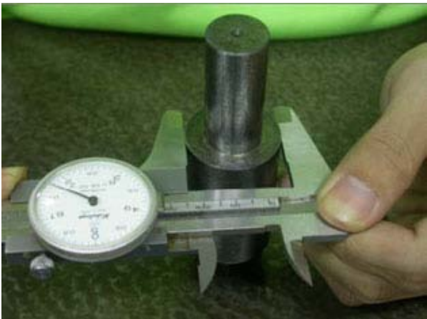
รูปที่ 4.4 เวอร์เนียร์คาลิปเปอร์แบบนาฬิกา
