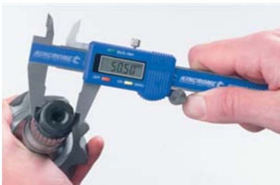
รูปที่ 4.1 การวัดขนาดชิ้นงานด้วยเวอร์เนียคาลิปเปอร์
