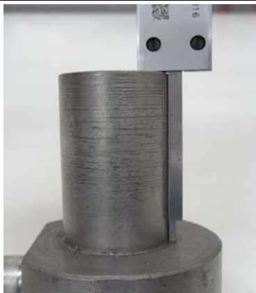
รูปที่ 4.10 วัดความลึกชิ้นงาน ที่มา : ณรงค์ อองอาจ ;2555
