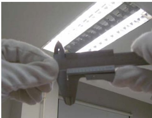
รูปที่ 4.39 ตรวจสอบปากวัดของเวอร์เนียร์คาลิปเปอร์
