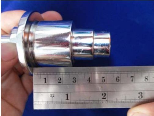
รูปที่ 3.16 การวัดชิ้นงานโดยเริ่มต้นจากขอบ ที่มา : ณรงค์ อองอาจ ;2555
